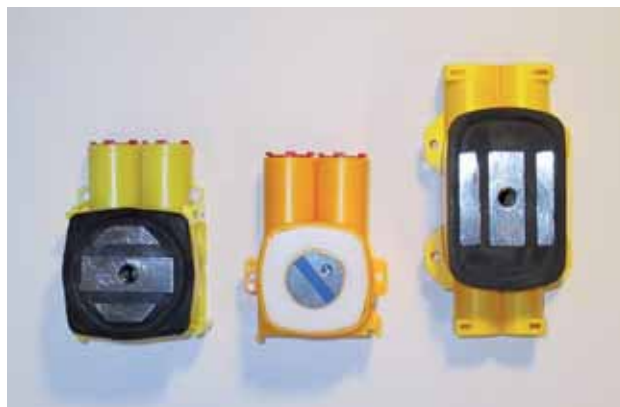
Figur 17. Vægelementer produceres overvejende på støbeborde af stål. Udspæringer, indstøbningsdele m.v. kan fastholdes til støbeformen med magneter. Der fås magneter til FUGA, OPUS og GLIM indstøbningsdåser. Billeder viser OPUS 1M, FUGA 1M og 1½M (gl. type) med ilagte magneter. Alternativt kan dåserne (dåselågene) klæbes til formen. Generelt er det nemmere at fastholde el-dåserne i formsiden end i op siden, og placering i formsiden er ofte mere præcis end placering i op siden. Hvis ikke andre hensyn taler imod det, så tilstræber man at producere elementerne sådan, at den vægside, der har flest indstøbninger, vender ned mod støbeformen.
